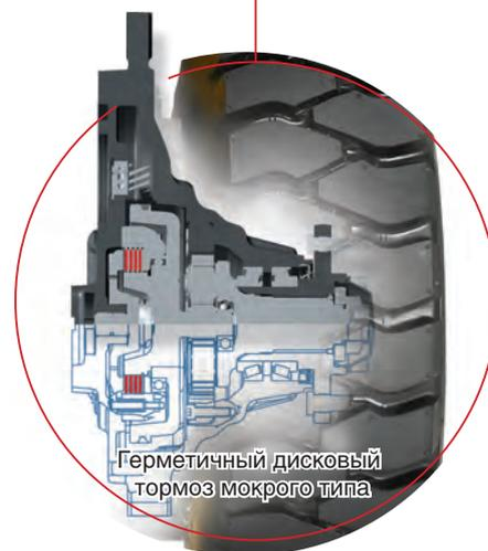
Герметичный дисковый тормоз мокрого типа
