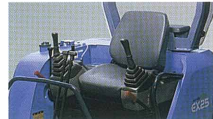
最適姿勢を保てるスライドシート シートが前後にスライド。しかもリクライニング式なので、体格や作業状況に合わせた楽なベストポジションが得られます。
