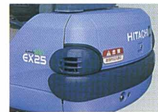
一層強化したハイガードプロテクタウエイト 従来よりガード面積を拡大。接触による損傷から、ボディカバーのコーナー部をガード。
